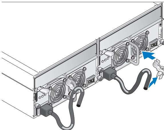
Conecte el extremo opuesto de los cables de alimentación a una toma eléctrica con conexión a tierra o a otra fuente de energía, como un sistema de alimentación ininterrumpida (SAI) o una unidad de distribución de alimentación (PDU).
