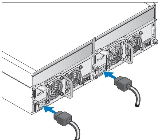
Conecte o suporte de retenção do cabo de alimentação à presilha na fonte de alimentação fixando o colchete posterior do suporte à parte superior da presilha e o colchete do meio à parte vertical no meio da presilha. Conecte o cabo de alimentação do sistema ao colchete do cabo localizado no suporte. Repita o procedimento para a segunda fonte de alimentação.
