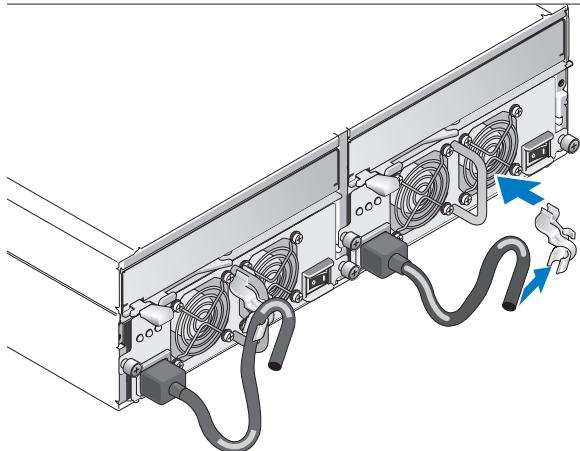
Branchez l'autre extrémité des câbles d'alimentation sur une prise de courant mise à la terre ou sur une source d'alimentation autonome (onduleur ou module PDU).
